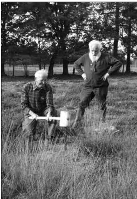
Untersuchung der welligen Oberflächenstruktur auf der Heide am Heiligen Meer mit Hilfe eines Handbohrstockes nach Pürkhammer.
